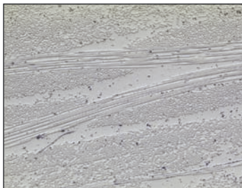
SPRINT 玻纤层板微观图片 - 0.33%的孔隙率
